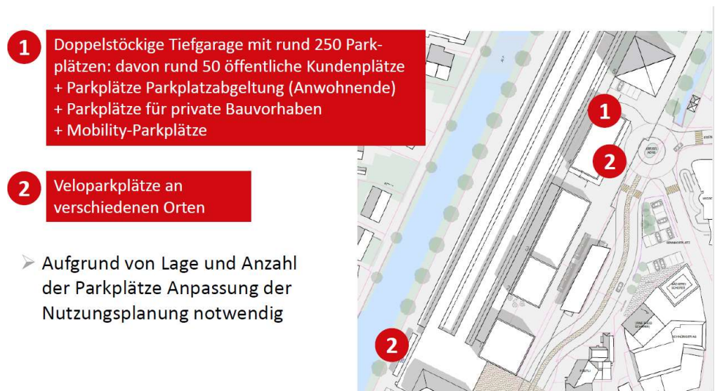
Abbildung 4: Veloparkplätze und Tiefgarage.
